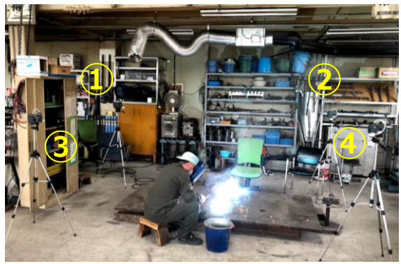
某溶接工場の気中マンガン濃度測定の結果 [mg/m 3 ]
