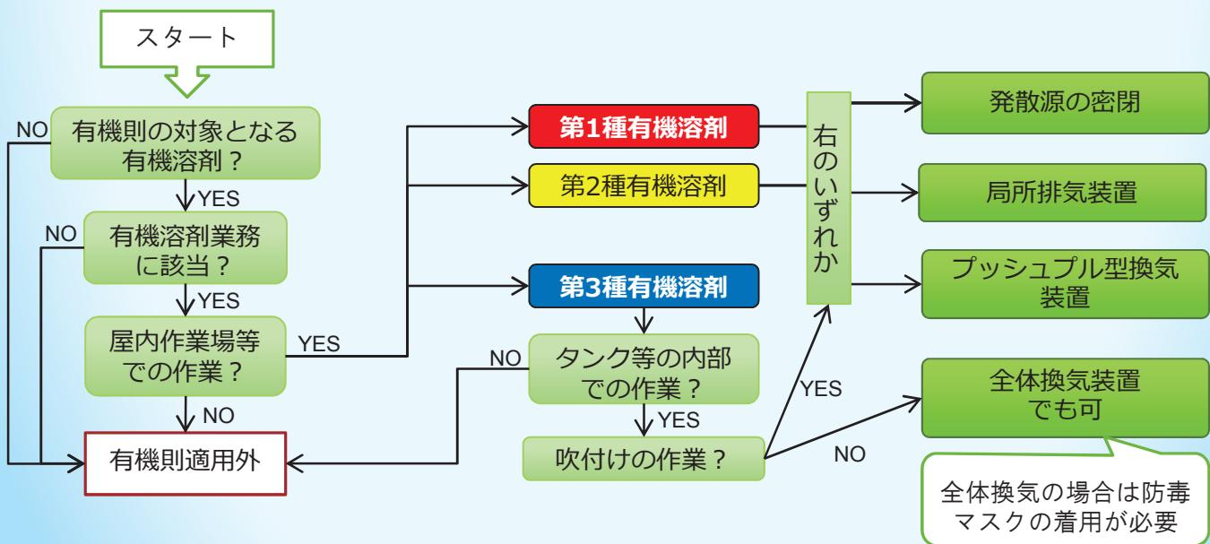
屋内作業場等において有機溶剤業務に労働者を従事させるとときは、その作業場所に有機溶剤の蒸気の発散源を密閉する設備、局所排気装置、ブッシュプル型換気装置等を設けなければなりません。
